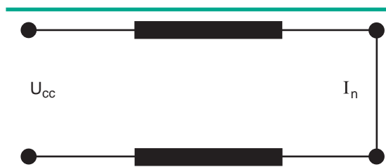
Fig. 13: Tensión de cortocircuito en una línea.
